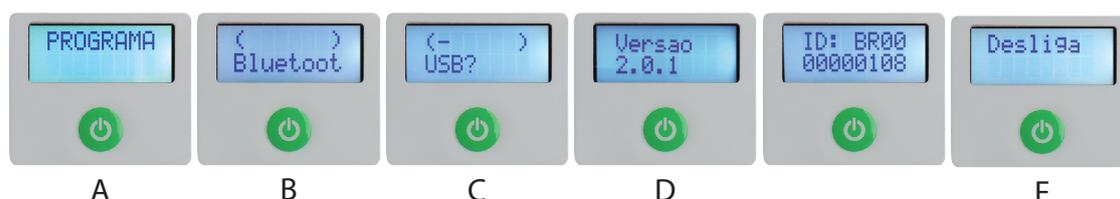
Com o aparelho desligado, é possível entrar diretamente em modo de programação bastando ligar o equipamento mantendo o botão pressionado por aproximadamente 5 segundos, até que apareça na tela o texto "PROGRAMACAO" conforme figura letra "A".
